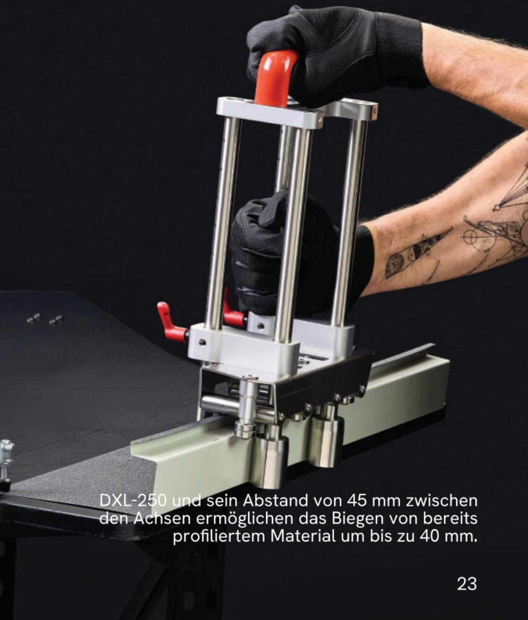
DXL-250 und sein Abstand von 45 mm zwischen den Achsen ermöglichen das Biegen von bereits profiliertem Material um bis zu 40 mm.
