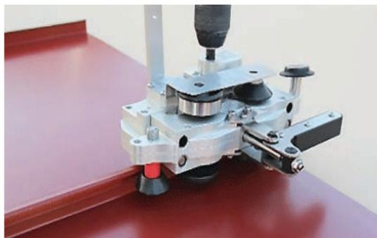
**2.** Setzen sie den Accuseamer mit den rot markierten Walzen auf und schließen sie den Falz.
